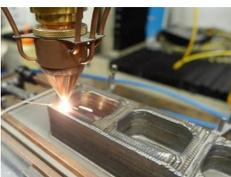
L'impression 3D métal combine l'impression 3D aux alliages métalliques à haute performance. Un laser de haute précision fusionne des particules de poudre métallique, permettant de
